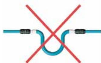
Per evitare depositi di condensa, installare sempre il giunto di dilatazione rivolto verso l'alto e non verso il basso
