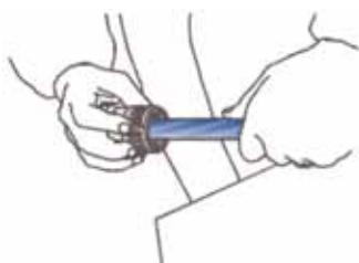
Con l'apposito smussature intervenire sulla parte esterna ed interna del tubo tagliato ed eliminare possibili sbavature e residui di taglio evitando che possano andare a depositarsi all'interno di apparecchiature pneumatiche
