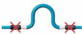
Evitare di ancorare il giunto di dilatazione a due raccodi diritti allineati sullo stesso piano
