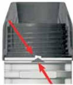
Se il raccordo è stato montato correttamente la base della ghiera si posizionerà a metà dell'indicatore di serraggio. Il freno ghiera ha la funzione di impedire un accidentale svitamento in caso di vibrazioni eccessive
