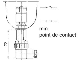
contrôle électrique de niveau
